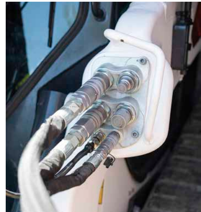
Aansluitblok met 5 koppelstukken voor Super Flow
