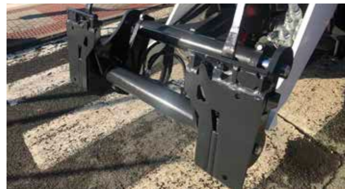
Quick-Tach™ naar Bob-Tach™ adapter (vereist voor alle aanbouwdeelen behalve bakken en palletvorken)
